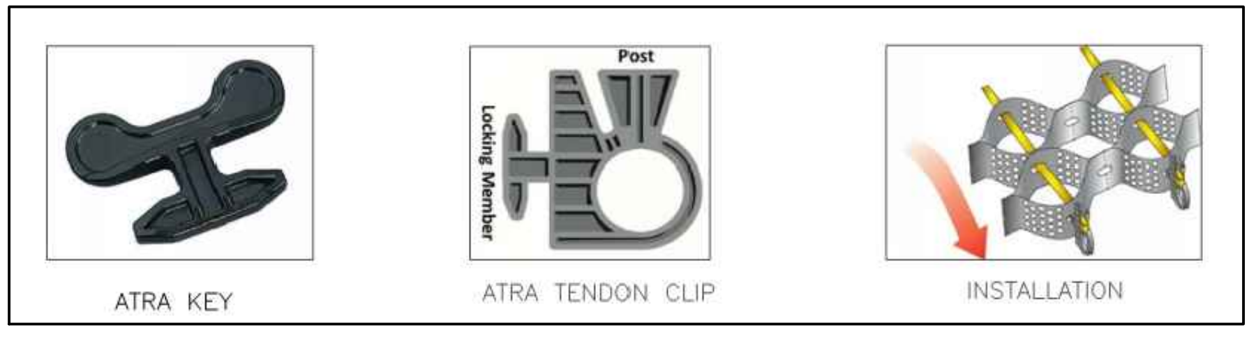
GEOWEB ATRA FASTENERS 6/9 N.T.S.
